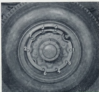
06-7 - Reihenfolge des Anzugs der Radmuttern hinten.
