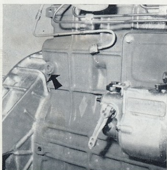
00-20 - Wasserablaßschraube auf dem Zylinderblock (hinten).
